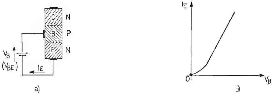
Fig. 169. - a) Alimentazione della giunzione base-emettitore in senso diretto; b) andamento della corrente di emettitore in funzione della tensione emettitore-base ( V_{BE} = V_B ).
